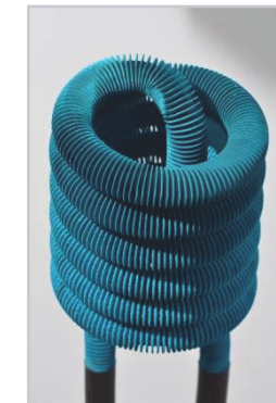
MOF-beschichteter Wärmeübertrager (Fraunhofer ISE)
